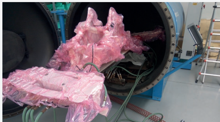
ALCUNE FASI DELLA REALIZZAZIONE DELLA MONOSCOCCA IN FIBRA DI CARBONIO, DALLA LAMINAZIONE AL PEZZO FINITO
